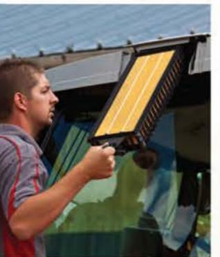
Воздушный фильтр кабины легко снимается для очистки
