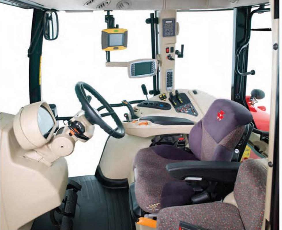
Подлокотник центра управления может быть оборудован многофункциональным джойстиком. Так, если он не используется для управления погрузчиком, то с помощью опциональной системы Datatronic 4 кнопки можно запрограммировать для управления другими функциями, в том числе:
