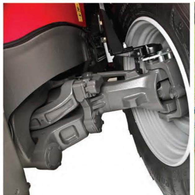
Передний мост с подвеской MF QuadLink позволяет еще больше повысить комфорт и улучшить контроль движения. Она отличается компактной и простой конструкцией, которая автоматически поддерживает постоянную высоту подвески вне зависимости от нагрузки на ось.
