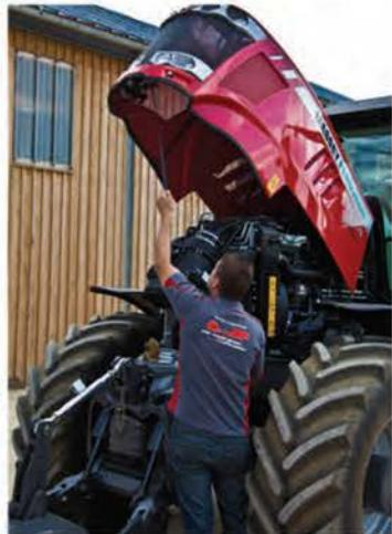
Система охлаждения с точно подобранными размерами отличается простотой доступа, очистки и обслуживания. 90% пыли удаляется естественным образом за счет тяги от вентилятора охлаждения. Воздушный фильтр двигателя также отличается простотой доступа и очистки.
