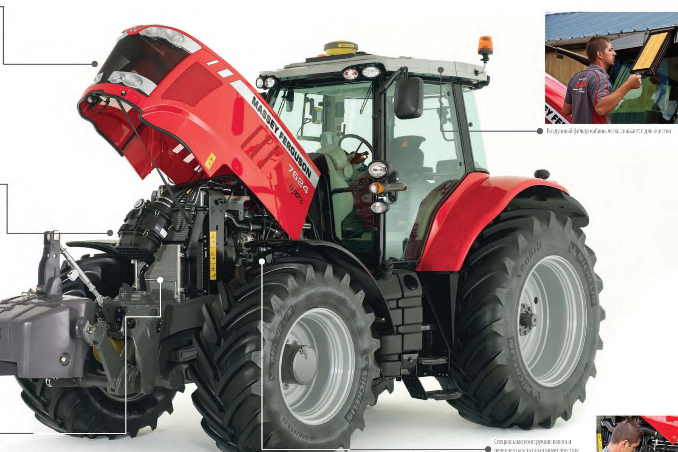
Специальная конструкция капота и переднего моста гарантирует простоту доступа к масляному фильтру двигателя и щупу уровня масла.
