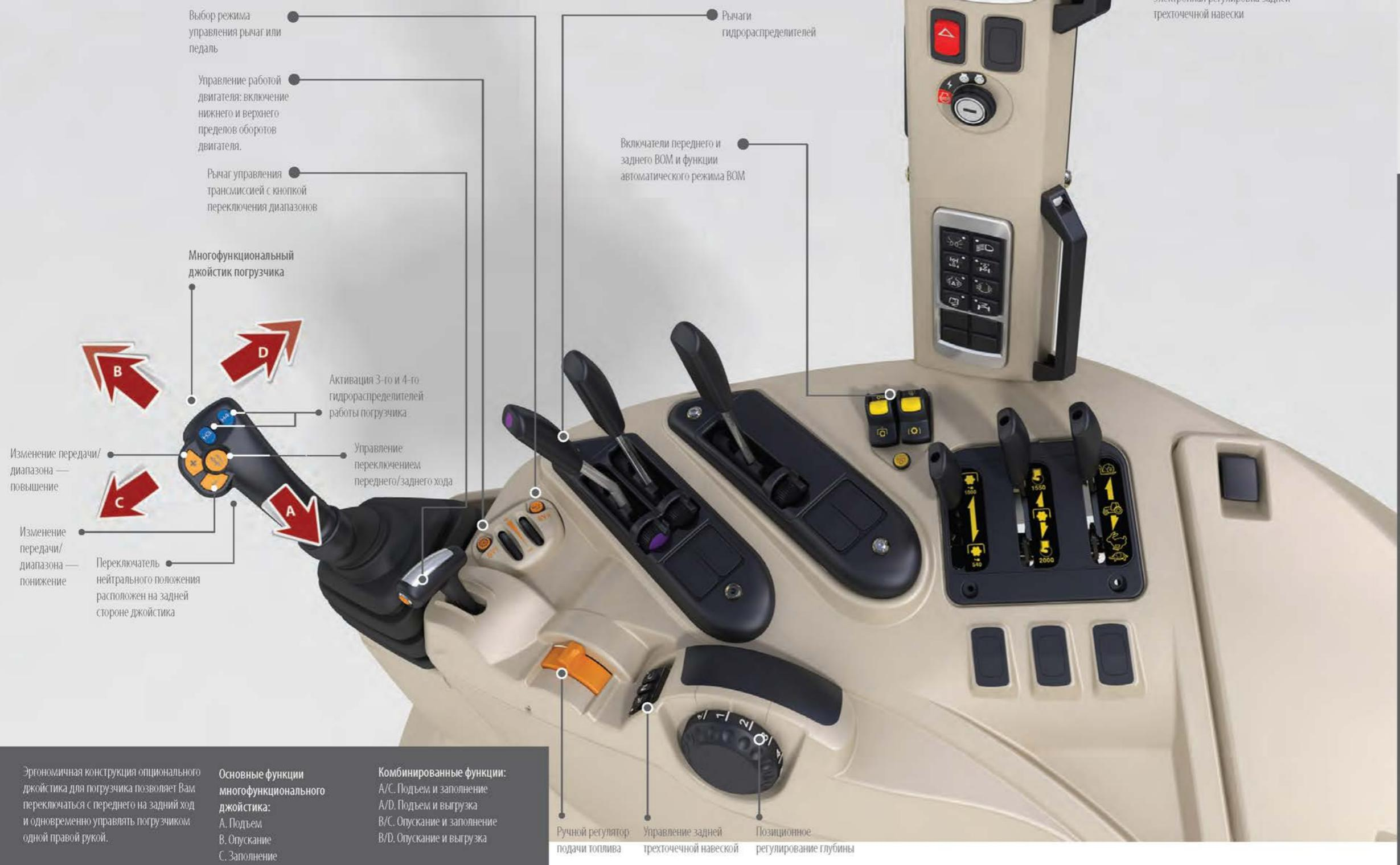
Эргономичная конструкция опционального джойстика для погрузчика позволяет Вам переключаться с переднего на задний ход и одновременно управлять погрузчиком одной правой рукой.
