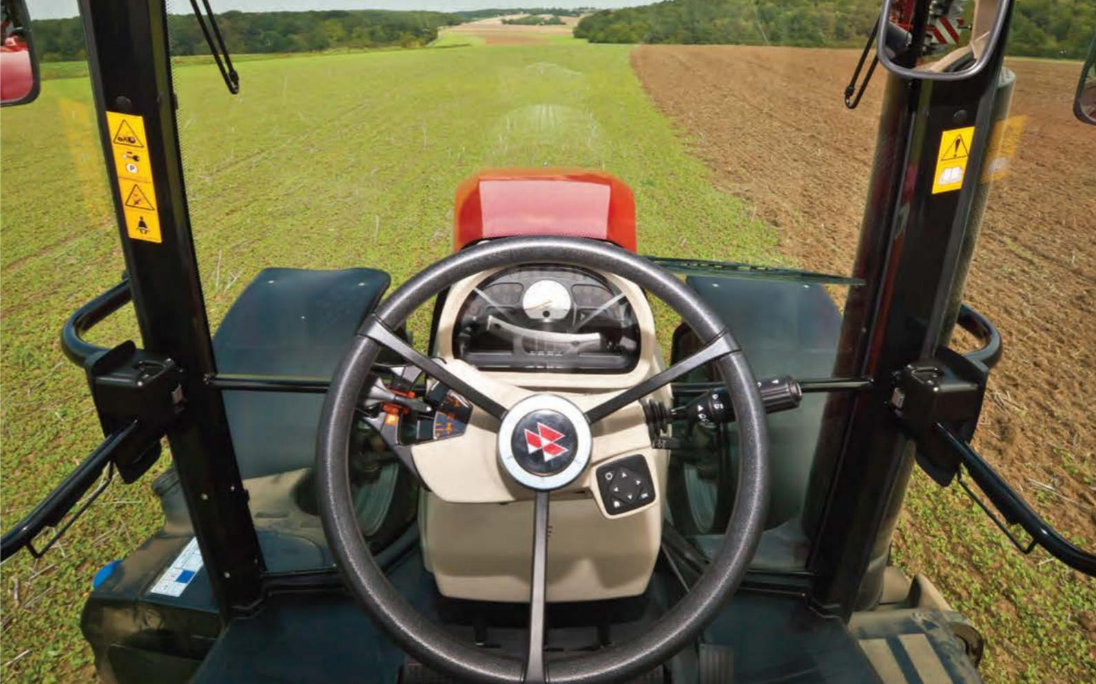
Модernизированная конструкция кабины обеспечивает превосходный панорамный обзор. Разумное расположение выхлопной трубы, капот специальной формы и большая площадь остекления в совокупности обеспечивают уникальный обзор на 360°. Беспрепятственный обзор из заднего окна гарантирует безопасность и полную видимость навесного оборудования.
