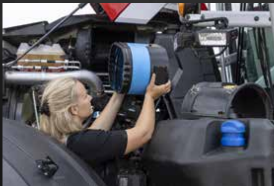
Повітряний фільтр двигуна легко діставати та чистити.
