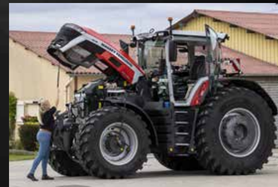
Передній міст і вузька конструкція капота спрощують доступ до контрольного щупа та фільтра
