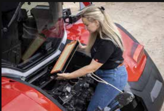
Легкий доступ для очищення повітряного фільтра кабіни.
