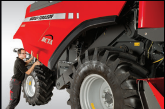
Цілісні панелі з сервісним підсвічуванням забезпечують відмінний доступ для обслуговування
