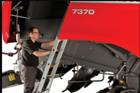
Безпечний доступ до моторного відсіку та зернового бункера за допомогою переносної драбини
