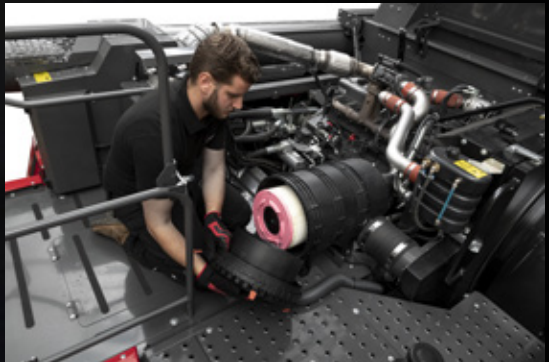
Перевірка й очищення повітряного фільтра
