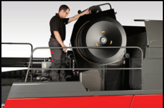
Безпечний і простий доступ до радіатора для очищення
