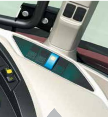
Новый комбинированный режим для производительности 98 л/мин, доступный нажатием кнопки
