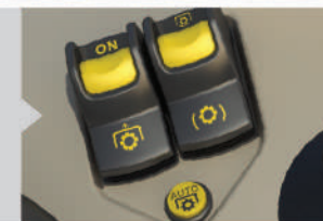
Перемикач вибору ВВП для командного центру та кнопка автоматичного вмикання
