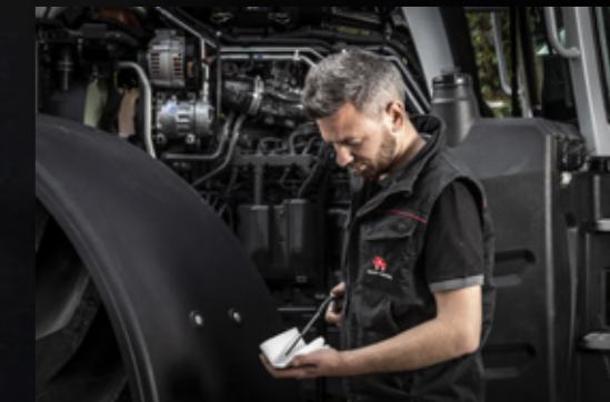
Передня вісь і вузька конструкція капота спрощують доступ до масляного щупа та фільтра.
