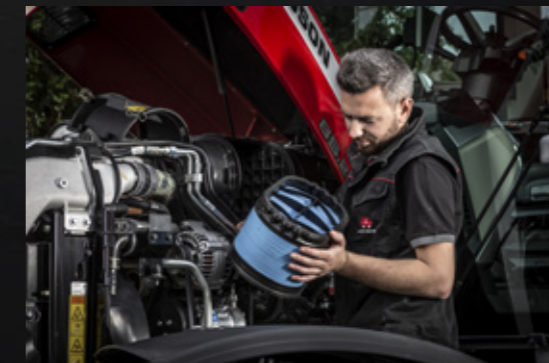
Повітряний фільтр двигуна відрізняється простотою доступу й очищення.
