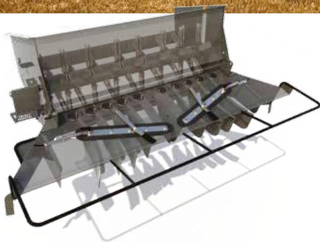
**6-ти рядный соломоизмельчитель** разработан специально для измельчения и разбрасывания соломы при применении в хозяйствах минимальной обработки почвы. Зазубренные лезвия ножей обеспечивают максимальное измельчение и уменьшают потребление энергии. Регулируемые стационарные контрольные ножи и дефлекторы позволяют полностью контролировать качество измельченной соломы и ее разбрасывание.
