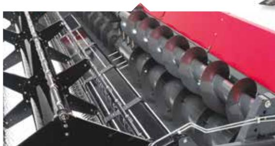
Дополнительный верхний рапсовый шнек, предлагаемый для жатки PowerFlow, увеличивает интенсивность подачи высокостебельных культур в наклонную камеру, тем самым значительно повышая производительность. Комплект для рапса дополняют два боковых ножа с электроприводом.
