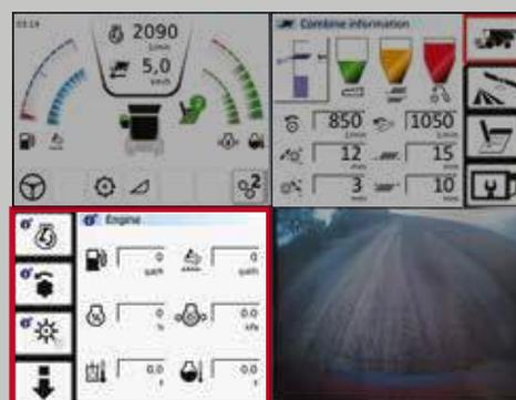
В левой нижней четверти экрана отображаются Страницы дополнительной информации. Здесь оператор может выбирать различные страницы, дающие детальную информацию о работе функций комбайна. Например, можно выбрать страницу, информирующую об оборотах двигателя и скорости вращения различных осей для быстрой диагностики работы основных систем.
