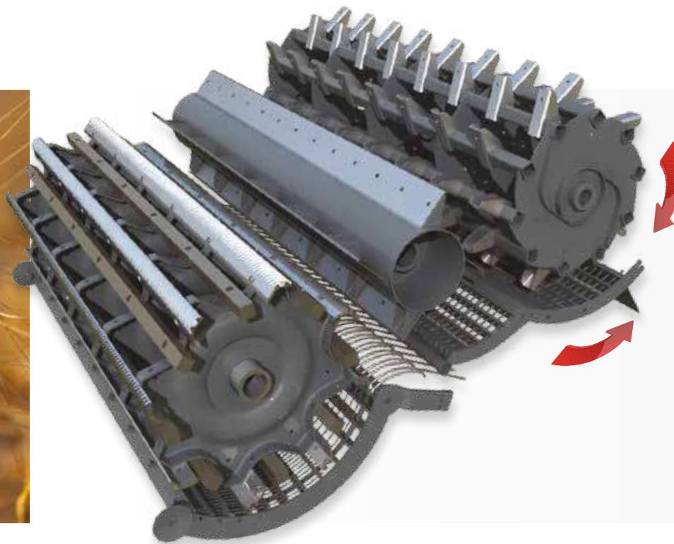
Молотильный барабан оснащен балластными брусками, которые значительно увеличивают его момент инерции при вращении. Это снижает нагрузку на приводы, потребление энергии и расход топлива.
