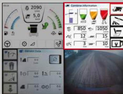
Легко читаемая Главная страница комбайна отображает реальную и заданную высоту жатки, уровень потерь на клавишах и решетках, а также объем массы идущей на домолот. Ниже находятся указатели оборотов барабана, зазоров подбарабья, оборотов вентилятора и зазоров решет – все эти параметры регулируются простым нажатием на соответствующий символ страницы.
