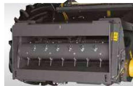
Приемный битер PFR, расположенный в передней части наклонной камеры, создает равномерный поток массы от жатки к транспортеру. Битер также участвует в процессе реверсирования наклонной камеры и жатки.
