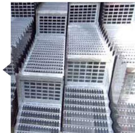
Длинные клавиши соломотряса оснащены четырьмя ступенями высотой 21 см - это самая большая высота среди клавишных комбайнов. Вертикальные стенки ступеней соломотряса так же имеют решетчатую поверхность для увеличения эффективной площади сепарации. Передние ступени клавиш усилены для работы с кукурузой.
