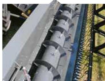
Расположенные по всей ширине шнека пальцы повышают его пропускную способность, обеспечивая равномерную и быструю подачу массы в наклонную камеру.
