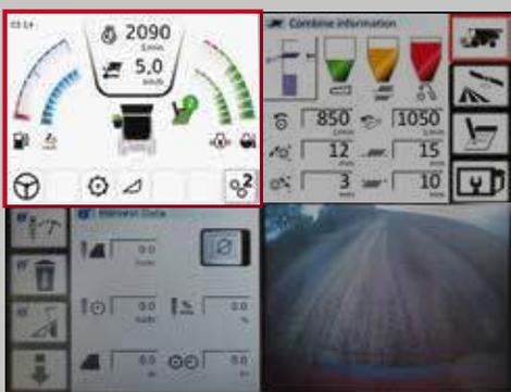
Страница общей информации находится в левой верхней четверти экрана. На ней отображаются обороты двигателя и скорость движения. По краям страницы находятся индикаторы уровней топлива, масла и температуры охлаждающей жидкости, а по центру виден текущий статус наполненности бункера и вылета выгрузного шнека.
