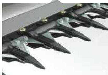
Режущий аппарат Schumacher – самый высокопроизводительный и качественный срез на скорости 1254 ходов в минуту. Самоочищающееся острое полотно ножа отлично работает в самых сложных условиях.
