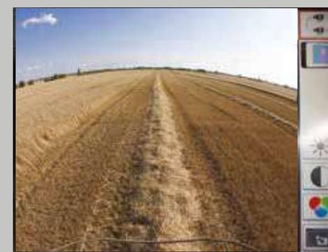
В нижней части экрана можно выводить до двух изображений от видеокамер. Оператор сам определяет необходимость постоянного вывода изображения или же, например, только при движении задним ходом. Простым нажатием на изображение можно быстро увеличить его размер до размера целого экрана.
