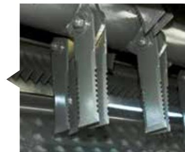
Для более интенсивного измельчения соломы в качестве стандартного оборудования устанавливается регулируемое днище, имеющее пупырчатую поверхность.
