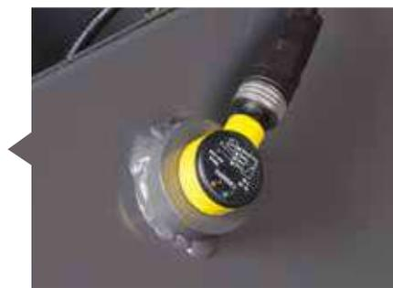
Датчик, измеряющий объем массы идущей на домолот, имеет наглядное отображение уровня на терминале в кабине, что позволяет оперативно контролировать работу комбайна.
