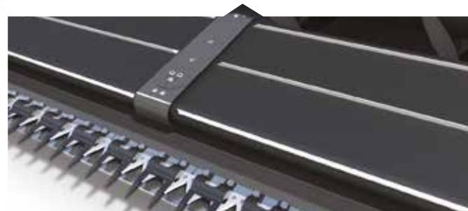
Большое расстояние от ножа до шнека (1,14 м) обеспечивает оптимальную видимость и подачу массы. Прочные ленты PowerFlow перемещают массу с постоянной скоростью от ножа в наклонную камеру. Ленты также отбрасывают мелкие камни, предотвращая их попадание в машину, где они могут вызвать различные повреждения.
