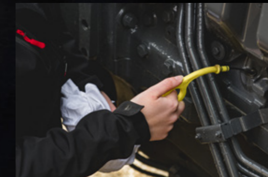
Передня вісь і вузька конструкція капота спрощують доступ до масляного щупа та фільтру.
