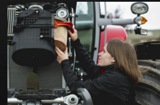
Повітряний фільтр двигуна легко діставати та чистити.
