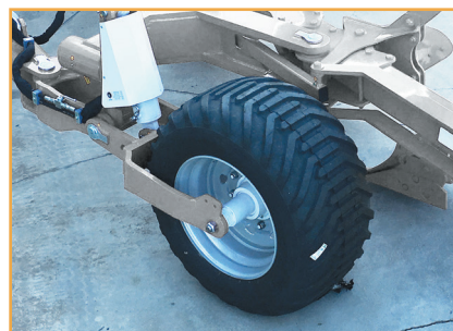
ГІДРАВЛІЧНЕ КОЛЕСО ДЛЯ КОНТРОЛЮ ГЛИБИНИ
