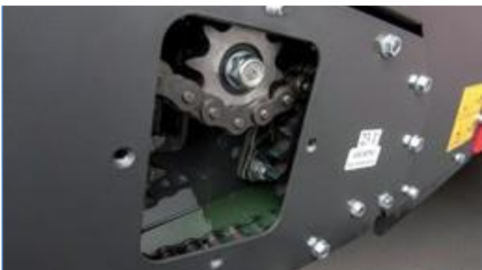
Елемент приводу з системою змащення в масляній ванні: без обмеження терміну експлуатації. Необхідність в заміні ланцюгів відсутня.
