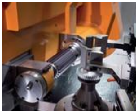
Зубофрезерний верстат з автоматичною подачею заготовок. Виробництво механізмів
